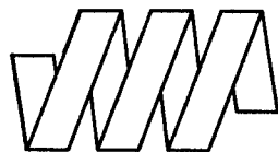
Рис. 10.6. Катушка с «плоской» намоткой
